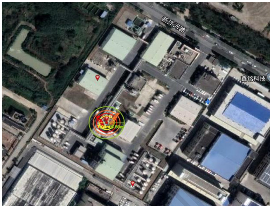
图 5-2 双氧水储罐物理爆炸事故后果模拟
