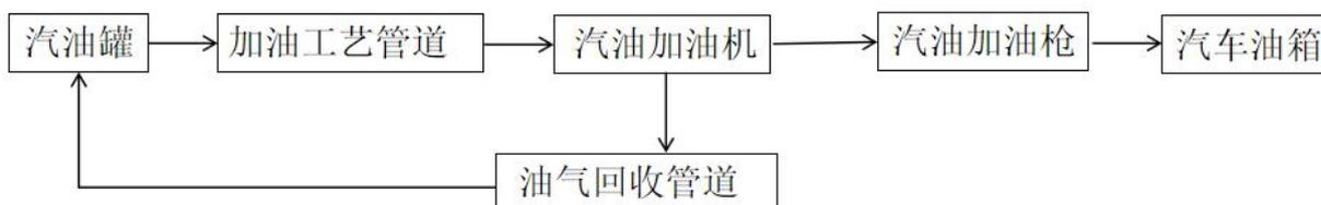
图 2-3 汽油加油及加油油气回收工艺流程图
