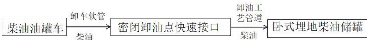
图2-2 柴油卸油工艺流程框图
